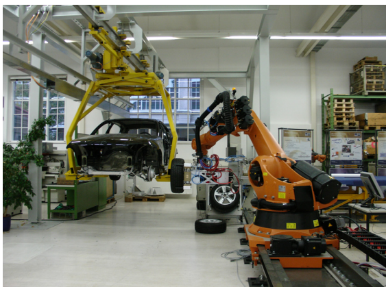
Bild 1: links: Gesamtansicht mit einem auf einer Linearachse montierten KUKA-Roboter und einer durch eine Elektro-Hängebahn transportierte Karosse; rechts: Detailansicht des Endeffektors mit nachgiebigem Kraft-Momenten-Sensor
