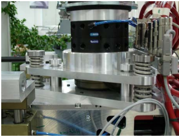
Bild 2: Kraft- Momentensensor für große Kräfte und Momente (Exo-Compliance)
