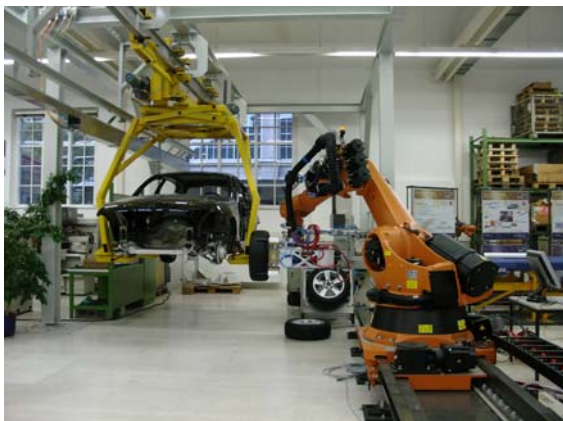
Bild 1: links: Gesamtansicht mit einem auf einer Linearachse montierten KUKA-Roboter und einer durch eine Elektrohängebahn transportierten Karosserie; rechts: Detailansicht des Endeffektors mit nachgiebigem Kraft-Momentensensor
