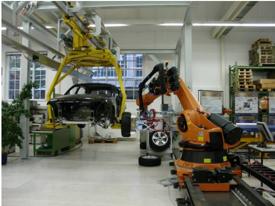
Bild 1: links: Gesamtanordnung zum Anbau von Rädern an bewegte Fahrzeuge rechts: Skizze der Anordnung mit durch das Achsloch blickender Kamera
