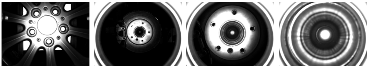
Bild 2: Bilder der robotergeführten Kamera (links: Rad in der Radaufnahme, Rest: Blick auf die bewegte Radnabe in unterschiedlichen Phasen der Montage)
